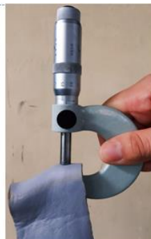
3-расм. Суюқлик билан ишлов берилган кўн ярим маҳсулот намуналарининг қалинлигини ўлчаш
