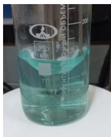
2. \text{CH}_2\text{COOH} кислота билан титрлаш
