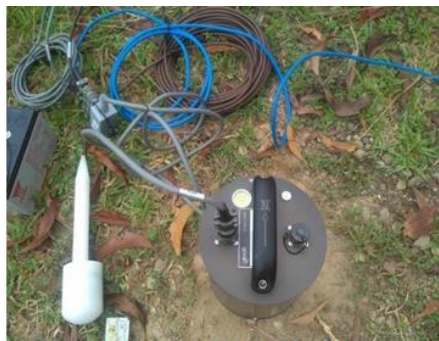
1-расм. Guralp 6TDE сейсмометри
