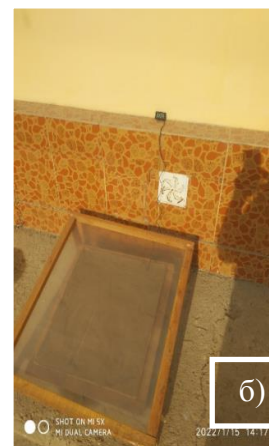
3-расм. Қуритиш жараёни. а) анъанавий ва композит плёнкалар остида қуритиш, б) композит плёнка остида қуритиш
