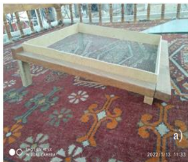
2-расм. Тажрибага қурилмаларни тайёрлаш. а) лой жойлаштирадиган токча, б) токчанинг плёнка остида жойлаши
