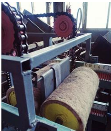
1-расм. Ҳўл кўн ярим маҳсулотидан суюқликни сиқиб чиқарувчи вертикал турдаги валли машина тажрибавий стенди
