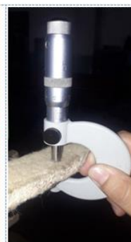
4-расм. Монитор қоплама қалинлигини микрометр ёрдамида ўлчаш
