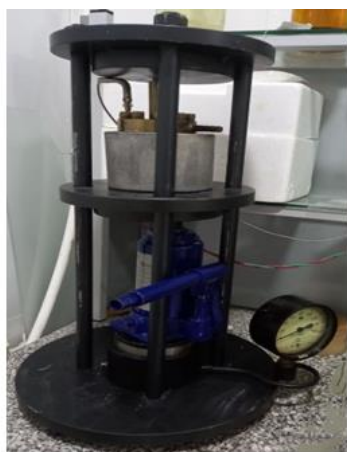
Рисунок 2. Вакуумное механическое устройство для заполнения сплавом в нанопоры темплатта АОА.
