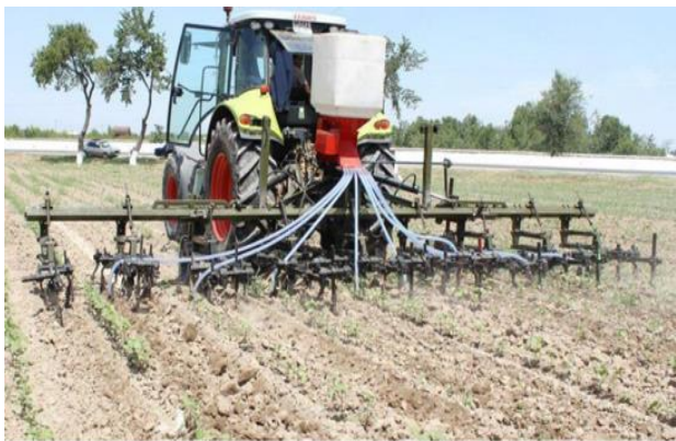
Рис. 2. Культиватор-растениепитатель в работе
