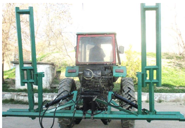
Рис. 1. Компонентная схема шарнирной рамы культиватора-растениепитателя
