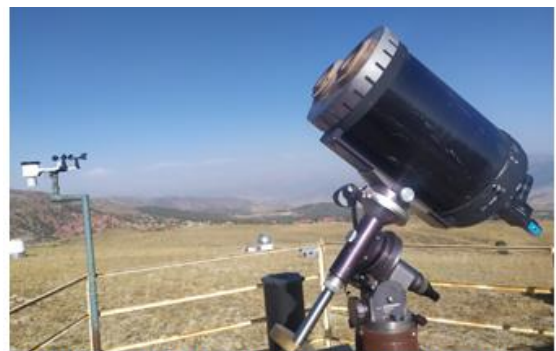
1-расм. DIMM ускунаси ва метеостанция
