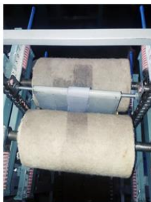
1-расм. Ҳўл кўн ярим маҳсулотидан суюқликни сиқиб чиқарувчи вертикал турдаги валли машина тажрибавий стенди
